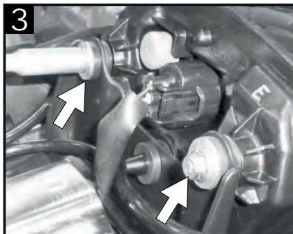
Anschließend die 4 Schrauben der Kennzeichenhalterung entfernen und diese entnehmen. Nun die Schrauben des Befestigungsadapters entfernen, diese entfallen.
