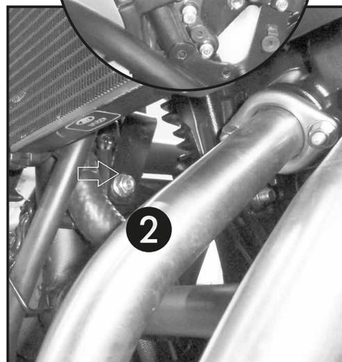
**2** Montage des Motorschutzbügels links mitte:
