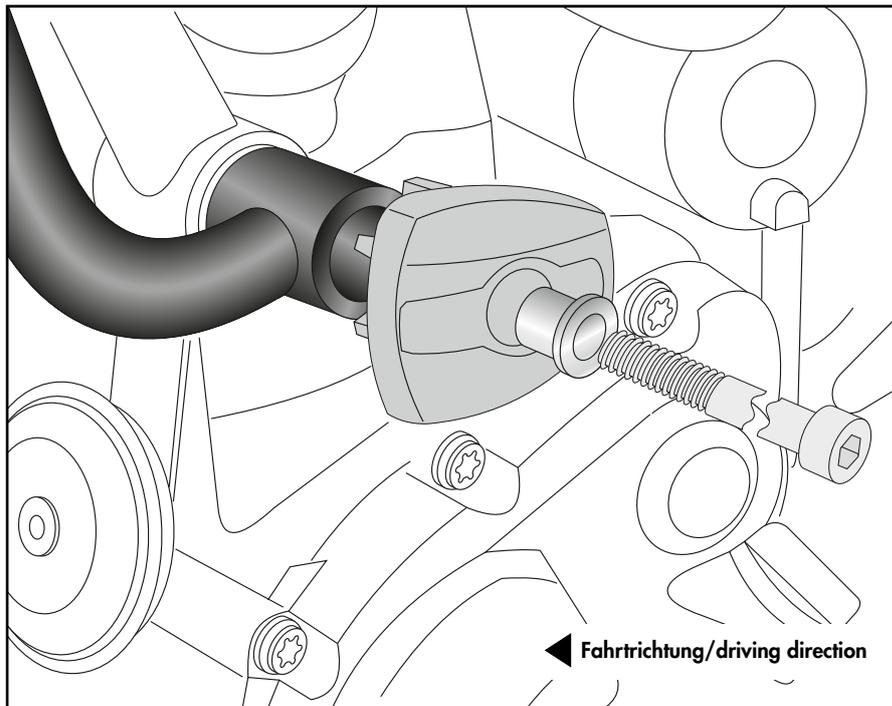
**Motorschutzbügel rechts/links hinten:**
