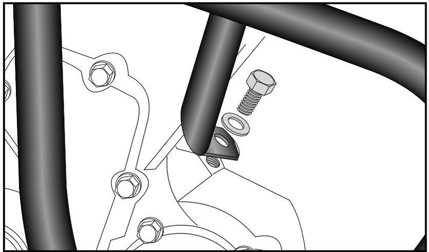
Montage des Motorschutzbügels links unten:
