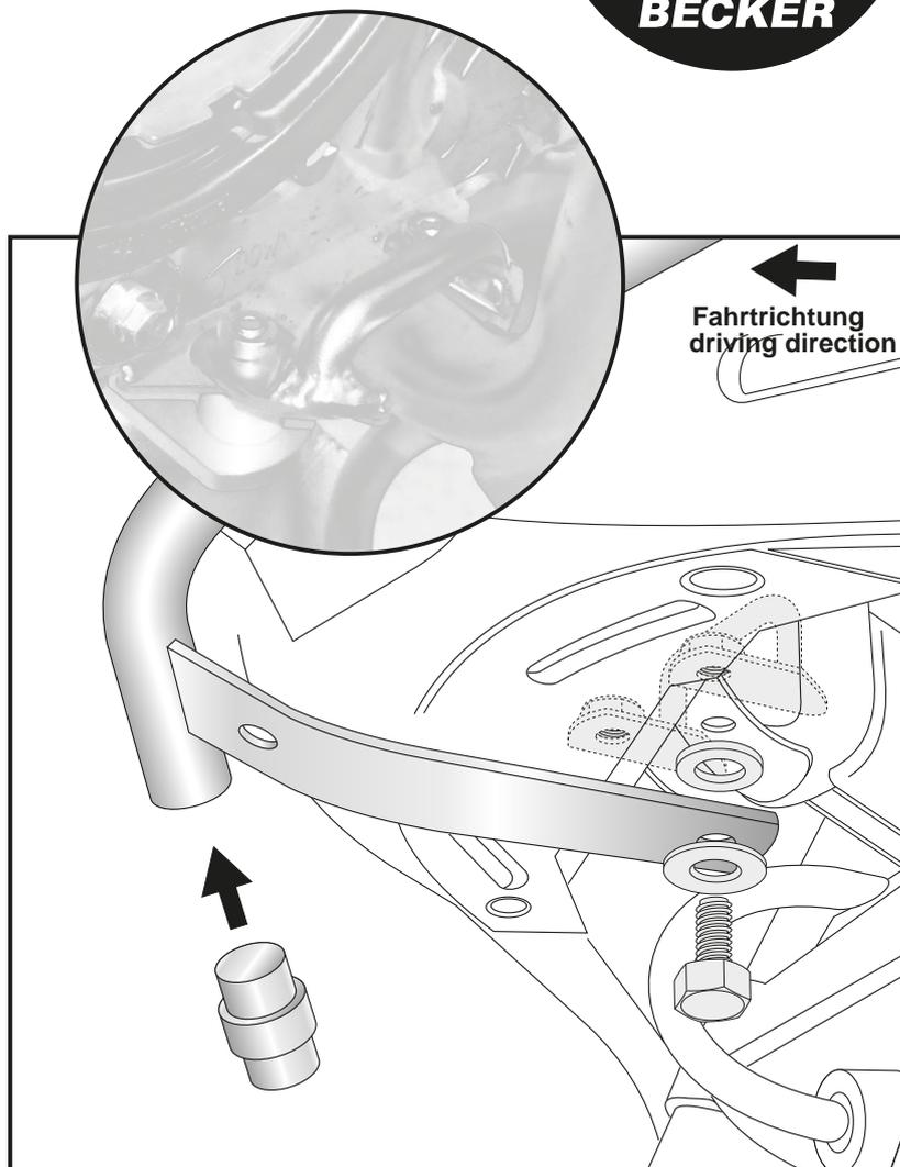
Den rechten Tankschutzbügel vorne mit dem bereits montierten, linken Bügel zusammenstecken.
