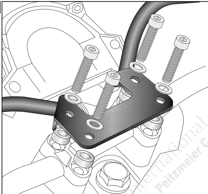
**Beim Festziehen der Schrauben an der Lenkerklemmung darauf achten, dass die beiden vorderen Schrauben zuerst festgezogen werden.**
