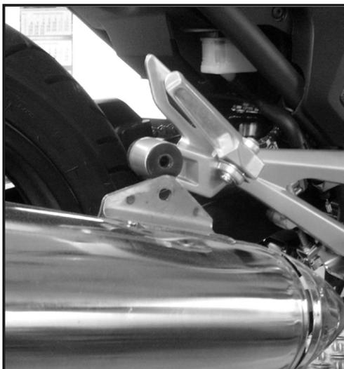
**3** Die Schrauben der Auspuffaufhängung vorne und hinten ausdrehen, den Topf nach unten ziehen und dann nach außen (siehe Bild).
