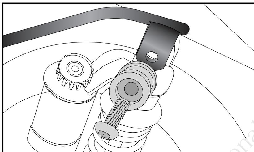
**3** Montage des C-Bow rechts: Dazu die Sechskantschrauben M6x16 und die U-Scheiben Ø6,4 verwenden.
