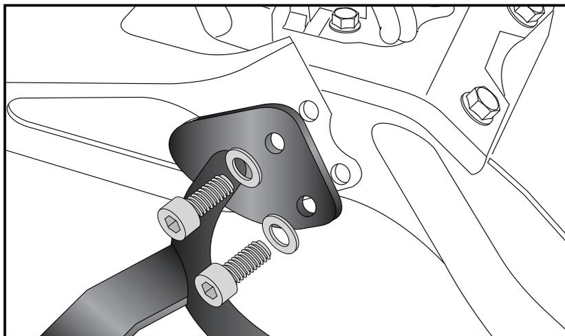
**2** Montage des Halteadapters rechts vorne: Den Halteadapter rechts vorne mit der Linsenkopfschraube M8x35 zusammen mit dem originalen Aluminium Gurtadapter montieren auf dem Federbein montieren.
