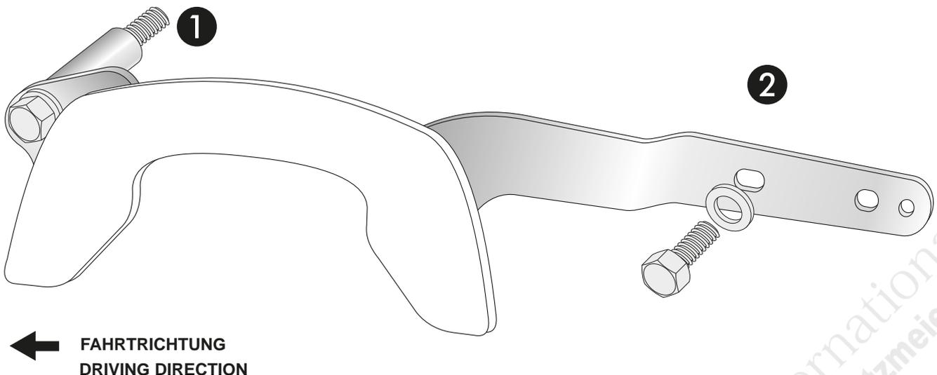
Die Blinker werden an den freien Bohrungen des Halteadapters mit der Originalbefestigung angebaut.
