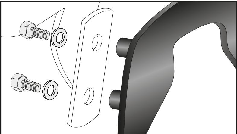
Bei gemeinsamer Montage mit dem Easy-Mini- oder Alurack wird der C-Bow Halter auf den Haltern des Racks verschraubt. Die Aludistanz Ø18xØ9x30mm vorne entfällt.
