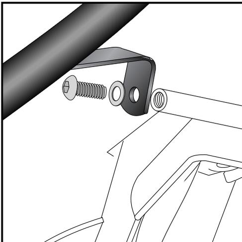
**7** Befestigung der Rohradapter oben links und rechts:
